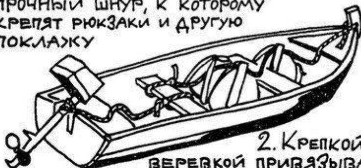
2. Крепкой веревкой привязывают к лодке подвесной мотор
